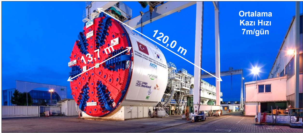
Resim 1: Tünel Açma Makinası (TBM)
